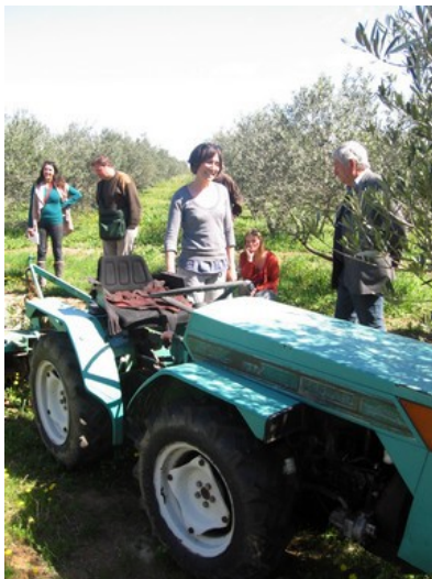
A g. : le tracteur (articulé entre les 2 trains), à dr. : l'attelage dents côtes de melon - rotavator
