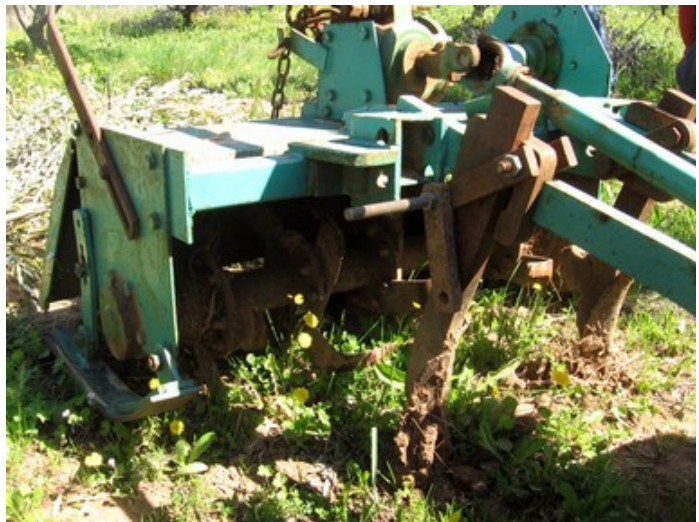
A g. : le tracteur (articulé entre les 2 trains), à dr. : l'attelage dents côtes de melon - rotavator
